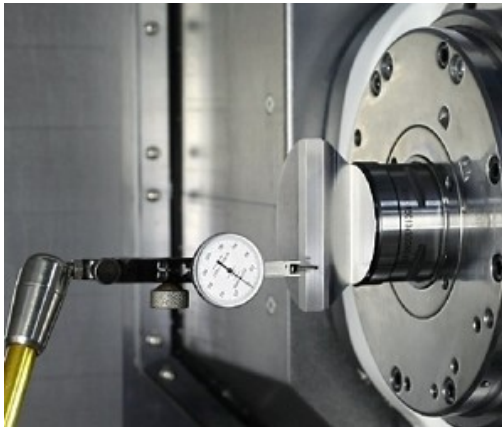
Kalibrierung der Spindelgenauigkeit von Fräs-Dreh-Maschinen
