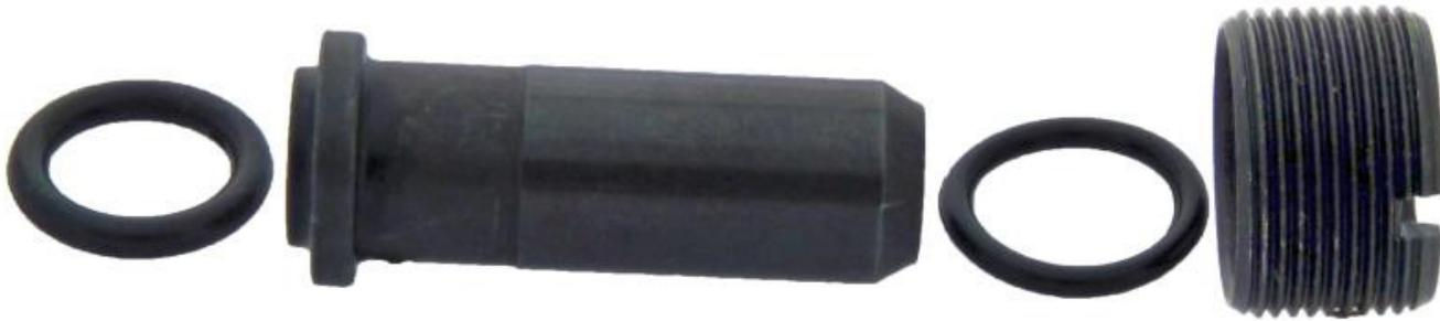
Bei Bearbeitung mit Innenkühlung müssen HSK-Aufnahmen Form A mit einem Kühlmittelrohr bestückt werden. Werden Aufnahmen mit Innenkühlung ohne Kühlmittelübergabeinheiten eingesetzt kann dies zur Beschädigung der Spindel führen.
